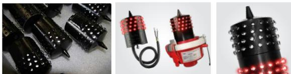
Feux de balisage rouges fixes à diodes électroluminescentes NAVILITE® (basse intensité et L-810) depuis 2003. La série NAVILITE est destinée uniquement au balisage nocturne de tous types d'obstacles d'une hauteur inférieure à 45 mètres, en particulier des pylônes d'antennes et des bâtiments à proximité des aéroports. Entièrement moulés avec 64 LED réparties en 16 circuits de LED indépendants, ils sont idéaux pour tous les types d'obstacles
