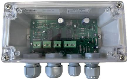
Ce boîtier de commande est défini pour faciliter le suivi des installations de lampes de balisage NAVILITE 48V. Il permet le raccordement de 2 lampes fonctionnant en redondance (1 en fonctionnement "normal" et la seconde en "secours") ou bien
