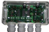
*Ce boîtier de commande est défini pour faciliter le suivi des installations de lampes de balisage NAVILITE 48V. Il permet le raccordement de 1 à 4 lampes fonctionnant simultanément (ou bien 2 lampes fonctionnant en redondance : 1 en fonctionnement "normal" et la seconde en "secours"), en permanence ou de nuit uniquement et avec détection d'alarme*
